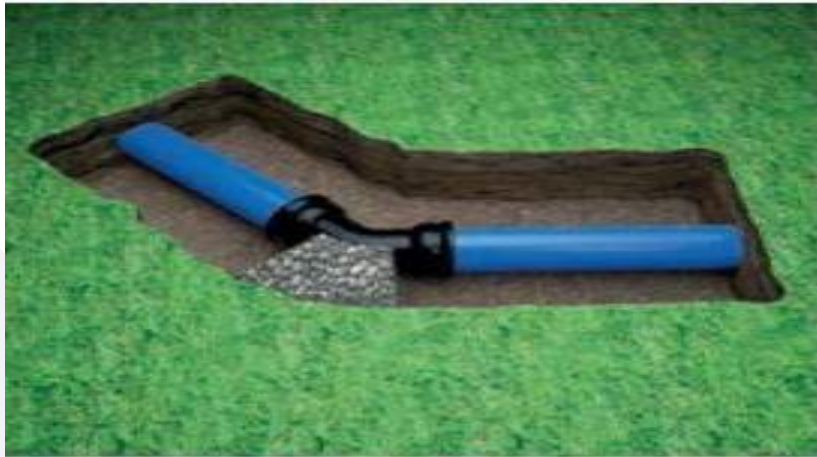
FIGURA 7 – DETALHE DE ANCORAGEM NA TUBULAÇÃO
