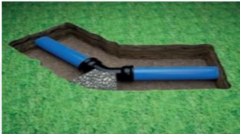
FIGURA 7 – DETALHE DE ANCORAGEM NA TUBULAÇÃO
